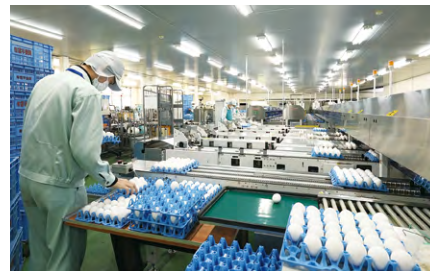
GPセンター設備
